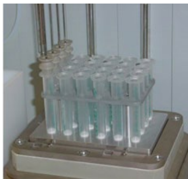
高通量的自动化固相萃取系统
