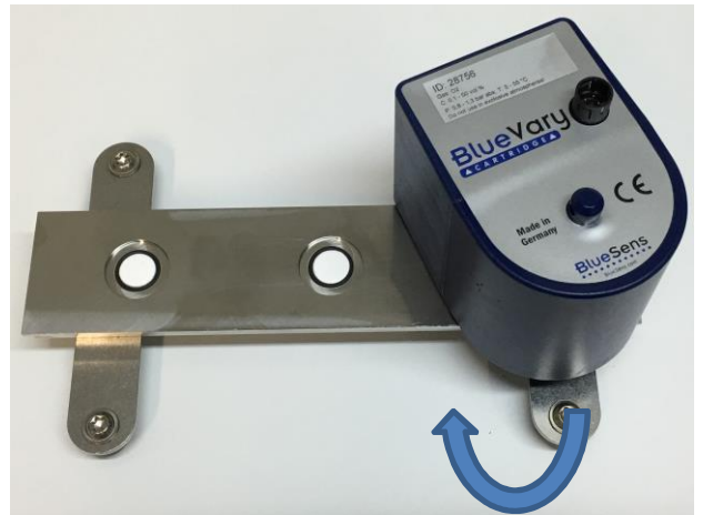
图9: 第一个试剂盒需要放在流量适配器的右侧
