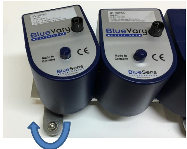
图11: 第三个墨盒需要以 10^{\circ} 角放置在第二个墨盒的左侧。要断开墨盒，从左侧开始。
