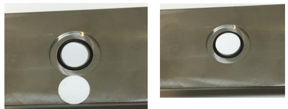
图5d: 安装的BlueVary过滤器和垫圈
