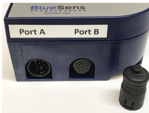
图14: 端口A: 电源输入、RS232、ModBus RTU 端口B: 3个模拟输出
