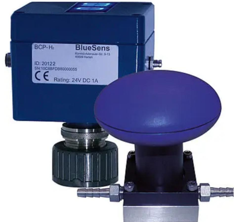
BCP-H<sub>2</sub>特别适合于藻类制氢领域。该传感器利用导热原理，这意味着它与其他气体具有交叉敏感性。交叉敏感度取决于混合物中其他气体的热导率。因此，该传感器适用于二元（不易燃）气体混合物，例如 H<sub>2</sub>/CO<sub>2</sub>、H<sub>2</sub>/N<sub>2</sub>和 H<sub>2</sub>/Ar。
