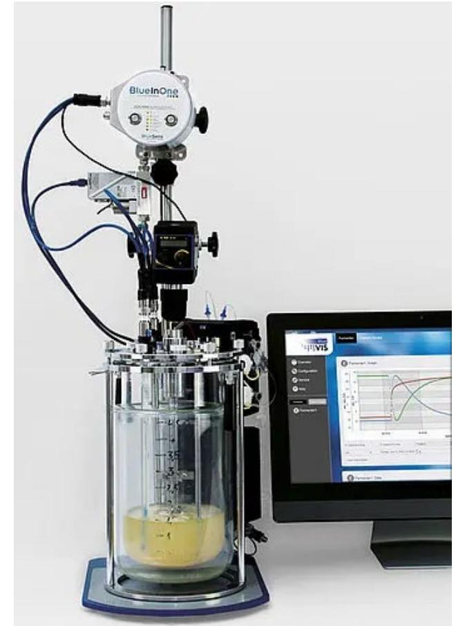
BlueInOne 设计用于测量生物技术细胞培养过程中的二氧化碳和氧气浓度。它可以集成到生物工艺的废气流中，在线实时测量气体浓度。分析仪位于无菌屏障后面，可以随时校准，没有污染培养物的风险。压力和湿度的波动会自动补偿。BlueInOne 适用于从台式到工业规模的所有发酵罐
