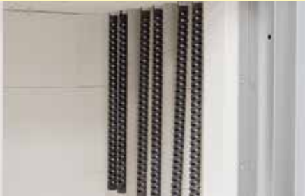
在一台高温炉上的排胶系统配有垂直悬挂式 SiC 棒和可选配的多孔进气管
