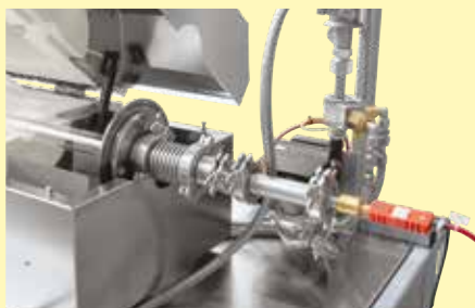
配备气体冷却器和物料热电偶的气密型旋转式接头
