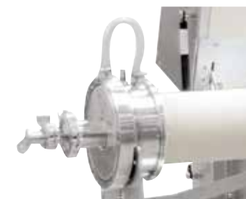
水冷式真空法兰（供气系统2）
