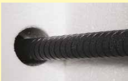
炉膛采用优质纤维材料，SiC加热棒位于炉两侧
