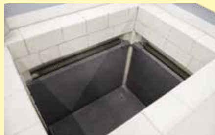
井式炉S 73/HS侧面和炉底，装有碳化硅板制成的保护装置
