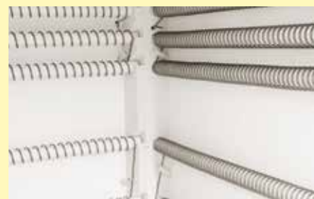
LF炉型的设计可缩短加热和冷却时间
