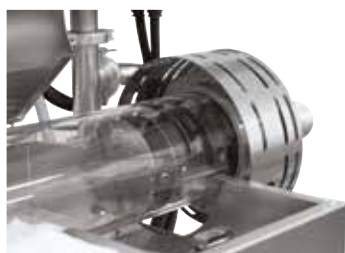
带热辐射防护片的法兰（供气系统15）
